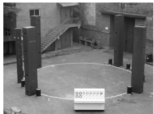
图5 多功能盾构隧道结构体试验系统
