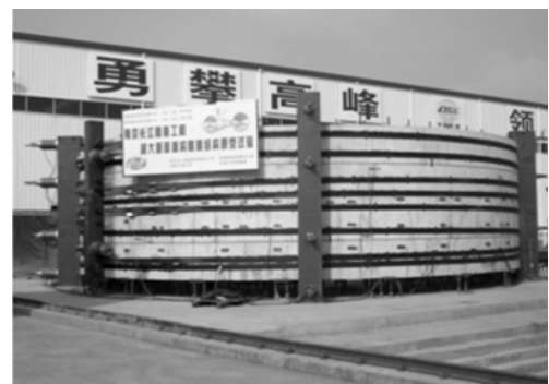
(a) 错缝拼装原型管片结构加载
