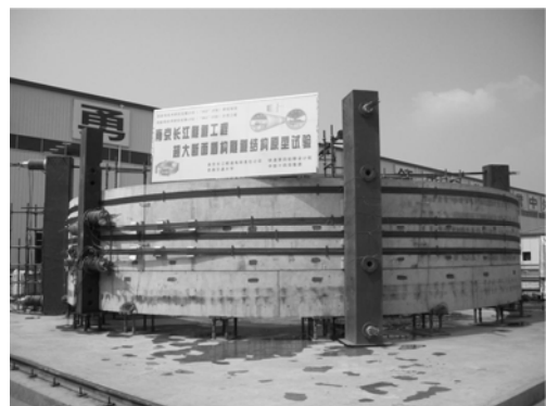
(b) 通缝拼装原型管片结构加载
