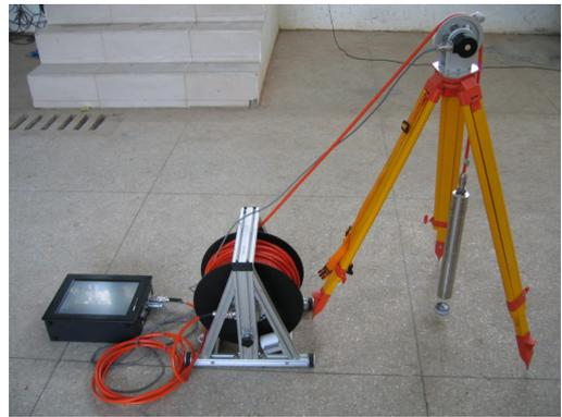
图3 深孔振荡试验设备
