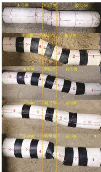
图 16 铰接隧洞变形
