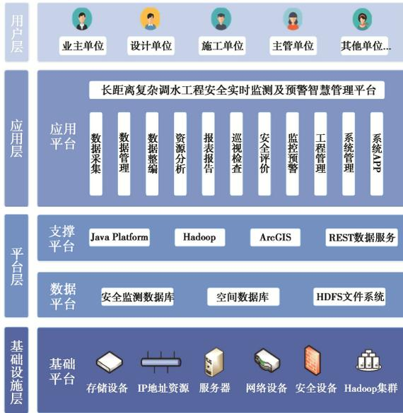
图 22 长距离复杂调水工程安全实时监测及预警智慧管理平台系统总体架构
