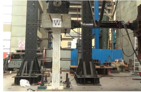
图 28 墩槽塑性铰力学性能试验
