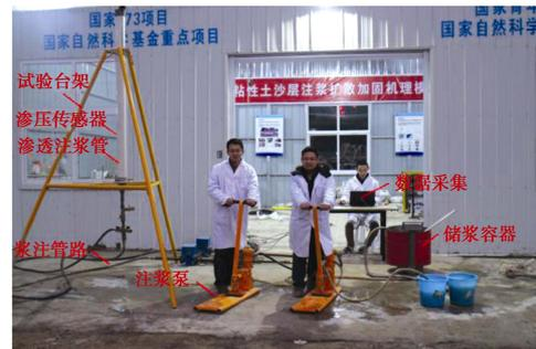
图 3 渗透注浆模拟试验系统
