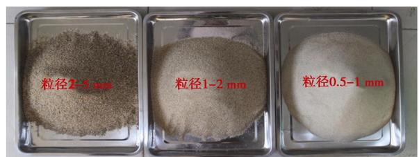
图 4 渗透注浆模拟试验被注砂样
