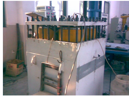
图 9 新型旁压仪探头和旁压模型试验
