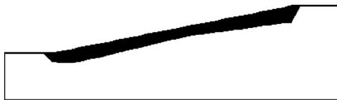
图 39 当堆积荷载  $q$  达到  $46 \text{ kN/m}$  时二阶功为负区域
