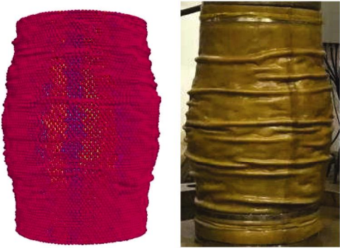
(b) 破坏形态进行对比 (500 kPa)
