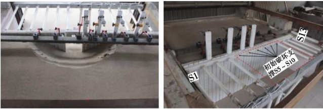
图 7 破坏完成后形成的稳定塌陷区
