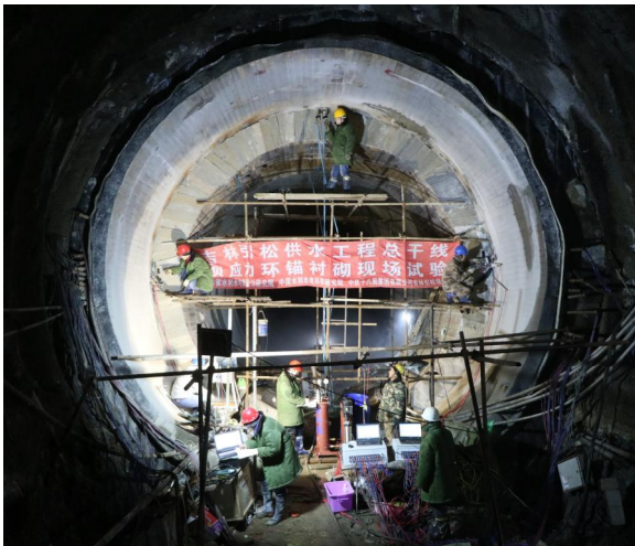
图 6 原位试验内水压力分级加载过程
