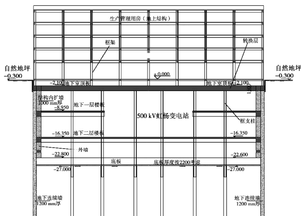
图 1 虹杨 500 kV 变电站结构剖面图
