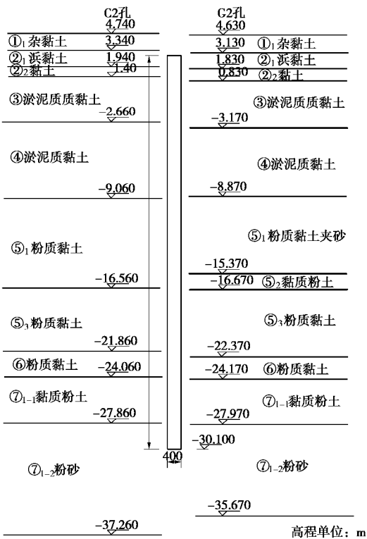
图 2 桩基剖面图(标高为绝对标高)
