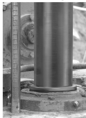
图 8 对钻机进尺进行摄像监测
