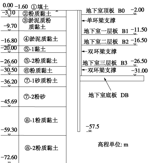
图 7 上海世博变基坑工程剖面图
