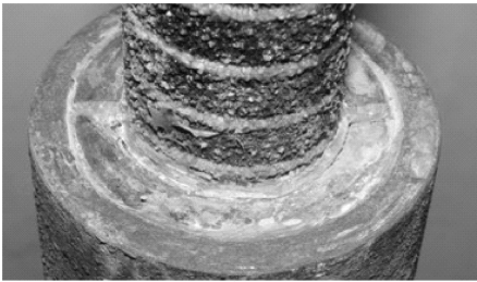
图 13 试件端部锚固完成后实物图
