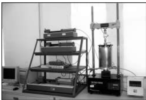
图 6 温控非饱和土三轴试验系统实景图
