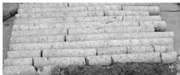
图 1 处理前钻孔芯样
