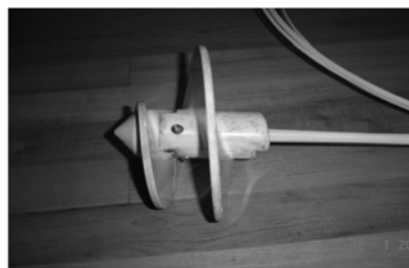
图1 螺旋锚结构和锚杆截面
