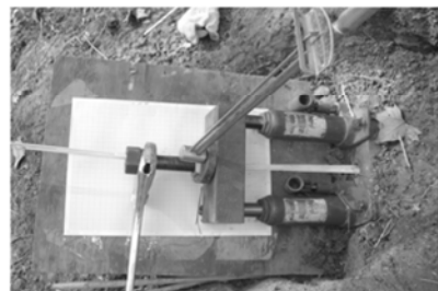
图4 拉拔试验布置
