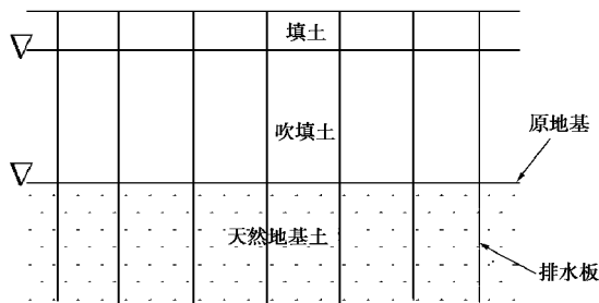
图 1 吹填土地基土层分布
