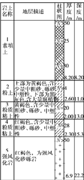
图 1 10000 kN·m 试验区钻孔柱状图
