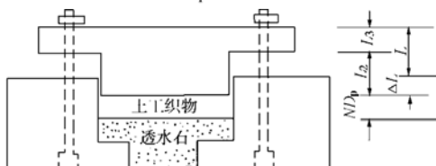
图2 织物试样装置示意图
