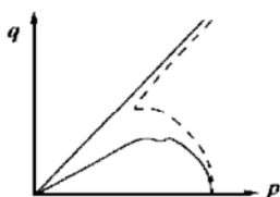
图 4 不排水实验时 p - q 平面的两种有效应力路径
