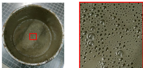
(a) 0.6 聚羧酸减水剂 (b) 左图红框部分放大图 图 11 PCFS 试验过程照片 (掺入聚羧酸)
