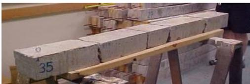
图 19 素混凝土最终断裂成 5 个部分<sup>[23]</sup>
