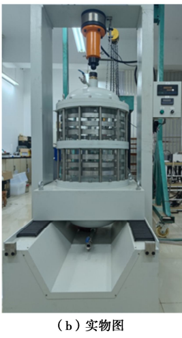
图 4 高应力、大直径土体渗透稳定试验装置 Fig. 4 High stress and large-diameter soil suffusion apparatus
