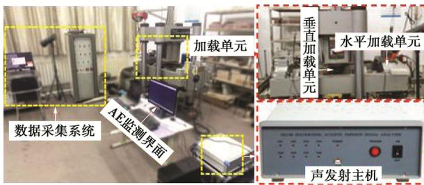
图2 剪切-渗流耦合试验系统及监测设备
