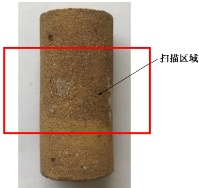
图 4 用于 CT 扫描的热冲击破裂砂岩圆柱体
