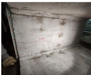
(c) 被动端侧壁 图 8 结构宏观破坏现象
