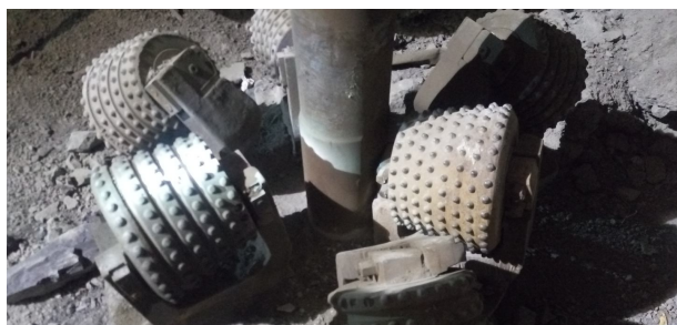
图 8 现场试验所用钻头
