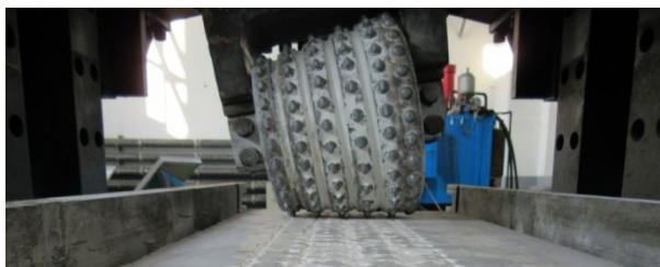
图 2 直线破岩试验
