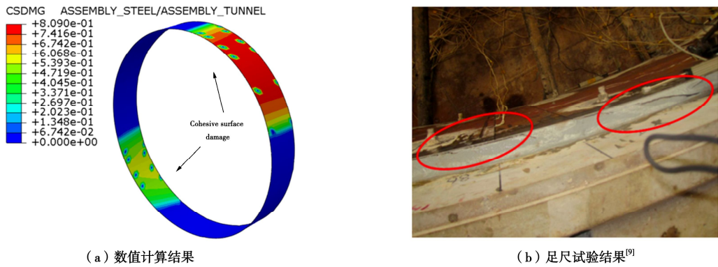
图 8 数值计算结果与试验界面破坏形态对比
