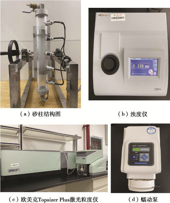
图 3 试验细节图 Fig. 3 Test details
