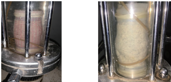
图 3 剪切过程中压力室内的三轴试样
