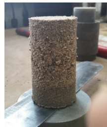
图 2 压样器中取出的具有一定颗粒排列的试样
