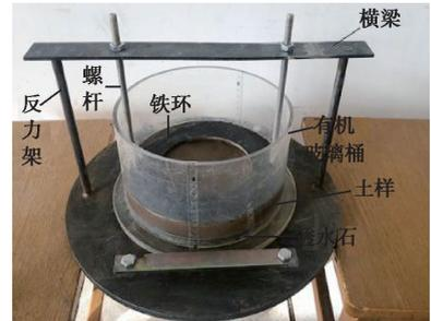
图 3 渗透破坏装置
