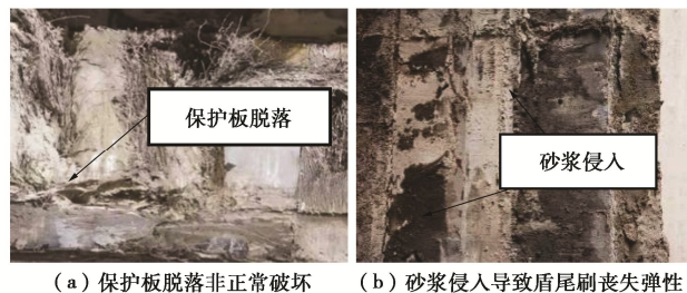
图 10 两种典型的盾尾刷破坏方式
