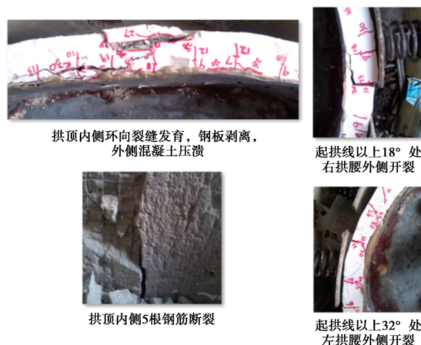
图 15 工况 4 结构最终破坏形态
