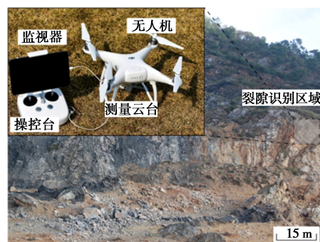
图 8 云南鲁奎山铁矿目标边坡与测量设备
