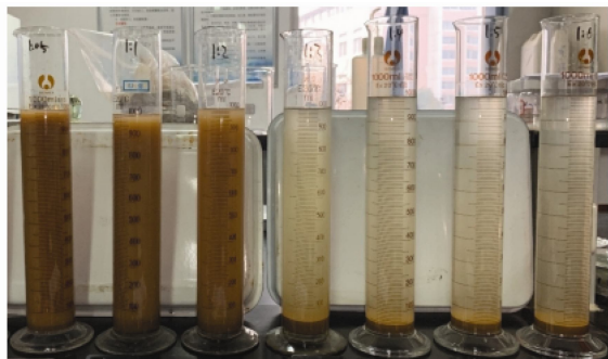
图 7 不同液固比非常规颗粒级配试验开始后 2 h 量筒情况
