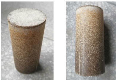
图 3 压制的砂岩试样
