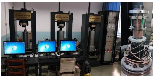
图2 TAW-1000岩石三轴蠕变试验机及试样安装
