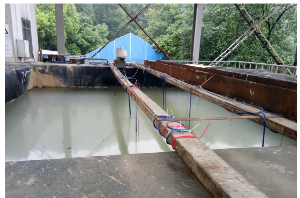
图3 自重固结阶段工程泥浆的表层状况
