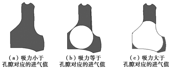
图 2 水分在孔隙中的迁移过程
