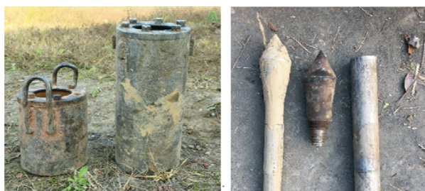
图3 现场 DPT 试验采用的穿心锤 (63.5, 120 kg)、探头和探杆 (直径为 42, 60 mm)
