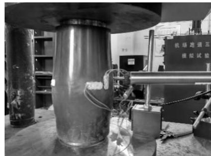
图1 典型约束固化土试件的破坏形态
