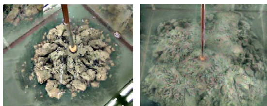
图5 第一层固化土(左)和第二层固化土(右)的浇筑情况 [12]
