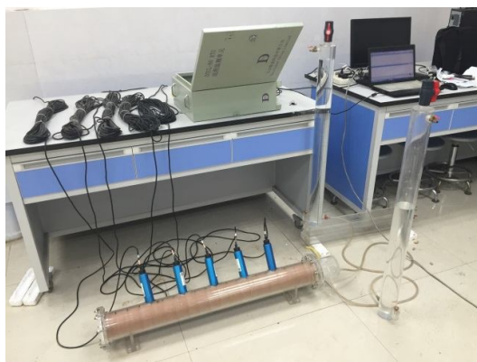
图1 非饱和土水平土柱入渗试验装置
