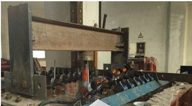
图 6 百分表布置 Fig. 6 Layout dial indicator
