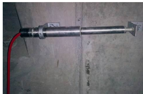
(b) 现场安装测缝计
