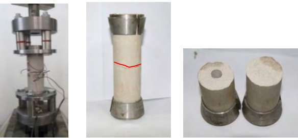
图 3 直接拉伸装置与破坏后试样端口形貌
