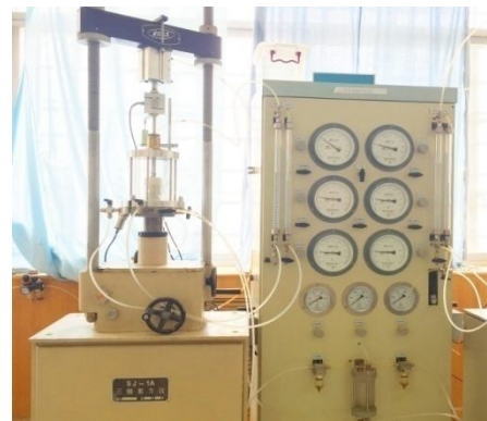
图1 非饱和土三轴剪切渗透仪
