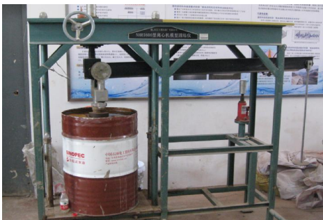
图 7 堆载预压模型试验示意图
