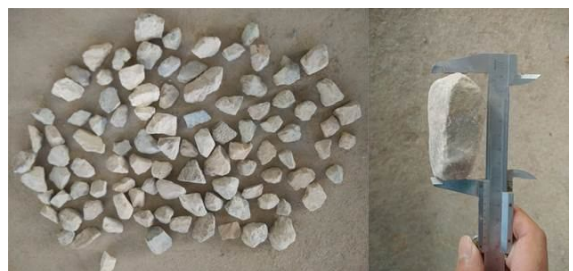
图 1 40~60 mm 碎石三向尺寸测量
