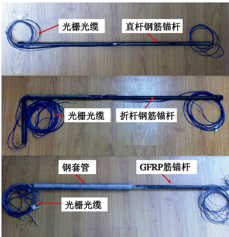
图 3 锚杆试样完成实物图
