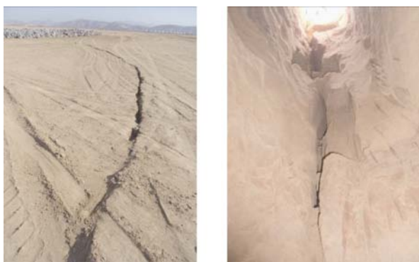
图3 坡体顶面地表裂缝展布及地下裂缝发育情况
