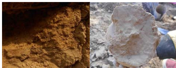
图5 剪出口探槽中揭示的滑带及擦痕面
