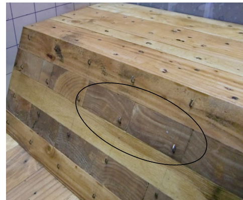
图 3 稳定陡坡及锚杆替代材料实物图
