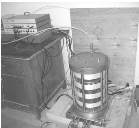
图 2 GDS-RCA 型固定-自由型共振柱
